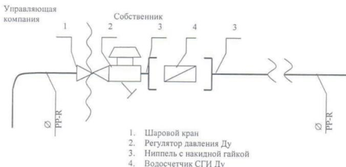
В состав общего имущества включаются внутридомовые инженерные системы холодного и горячего водоснабжения и газоснабжения, состоящие из стояков, ответвлений от стояков, указанных отключающих устройств, коллективных (общедомовых) приборов учета холодной и горячей воды, первых запорно-регулировочных кранов на отводах внутриквартирной разводки от стояков, а также механического, электрического, санитарно-технического и иного оборудования, расположенного на этих сетях.
